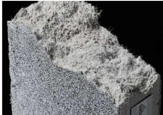
L'**UHPFRC** (Ultra-High-Performance Fiber-Reinforced Concrete) è un calcestruzzo fibrorinforzato ad altissime prestazioni, caratterizzato da una resistenza a compressione superiore a 150 MPa e una resistenza a trazione maggiore di 5 MPa<sup>1</sup>.
